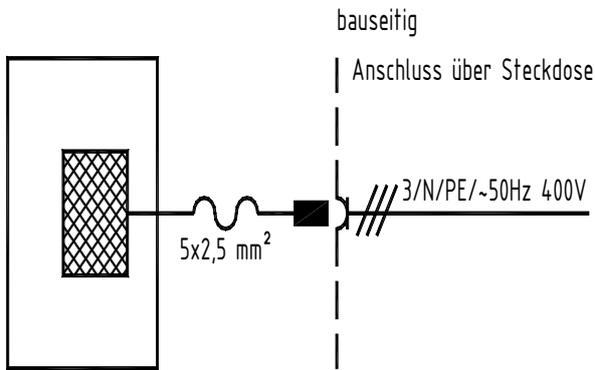
**3) 13,5 kW Drehstromanschluss**
