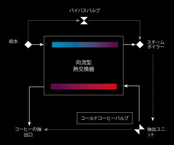
\*選択されたドリンクのみ向流型熱交換器を通ります。その他のドリンクは通常の温度で通常経路を通り提供されます。
